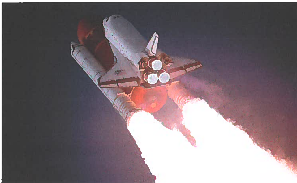
► 4.24 Le moteur des navettes spatiales fonctionne à l'aide de la réaction du dihydrogène avec du dioxygène, ce qui entraîne la formation d'eau.
