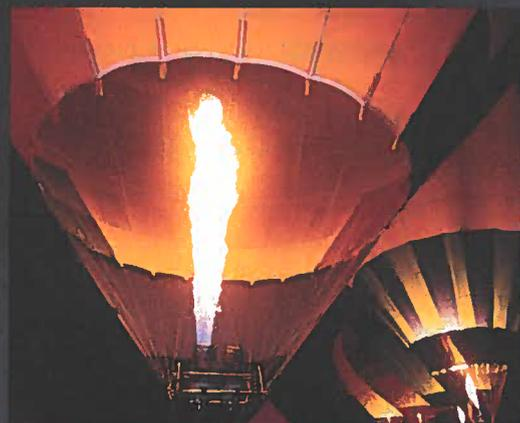
Dans une montgolfière utilisant un brûleur au propane, comme celle-ci, la température de l'air à l'intérieur du ballon peut se situer entre 80 °C et 100 °C.
