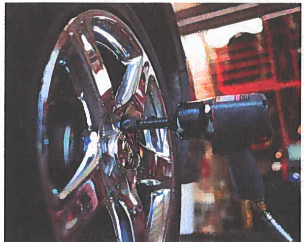
► 1.3 Une boulonneuse pneumatique fonctionne à l'aide d'air comprimé.
